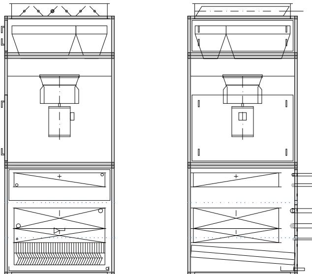
Аппарат приточного воздуха в вертикальном исполнении, вентиляционный канал сверху, заслонка канала наружного воздуха, бескорпусной вентилятор, оснащенный капельным воздухоочистителем.
