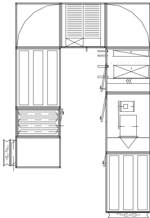
Комбинированный аппарат (приточный и рециркулирующий воздух) с пластинчатым теплообменником, заслонкой приточного воздуха и отработанного воздуха, 2 секциями, поворачиваемыми на 90° (в каждой приточный и рециркулирующий воздух), 4 глушителями шума в каналах наружного воздуха, приточного воздуха, рециркулирующего воздуха и отработанного воздуха. Контур приточного воздуха: воздухозаборник сбоку. Контур рециркулирующего воздуха: выпускное отверстие сверху.
