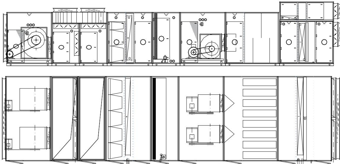
Комбинированный аппарат (приточный и рециркулирующий воздух) с заслонкой каналов наружного воздуха, отработанного воздуха и рециркулирующего воздуха, 2 вентилятора для приточного и рециркулирующего воздуха, каждый с преобразователем частоты электропитания. Контур приточного воздуха: сотовый увлажнитель, глушитель шума , 2-зонная система для приточного воздуха.
