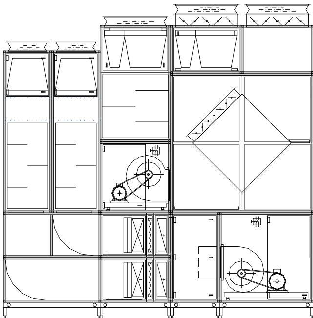
Комбинированный аппарат (приточный и рециркулирующий воздух) с пластинчатым теплообменником, заслонкой канала приточного воздуха и канала отработанного воздуха. 2-зонная система для приточного воздуха. Глушители шума в каналах приточного и рециркулирующего воздуха.
