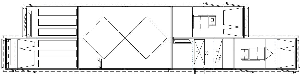
Защищенный от атмосферных влияний комбинированный аппарат (приточный и рециркулирующий воздух) с двойным пластинчатым теплообменником, рециркуляционной заслонкой, заслонкой приточного воздуха и отработанного воздуха. Контур приточного воздуха: второй каскад фильтров и глушитель шума в канале наружного воздуха. Контур рециркулирующего воздуха: глушитель шума.
