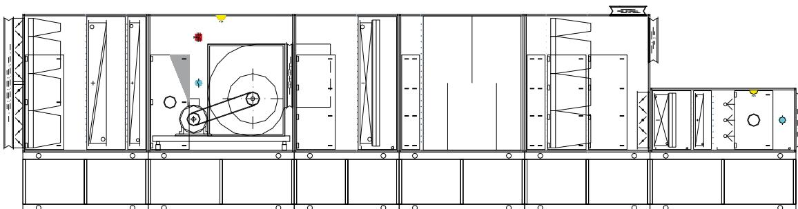
Аппарат приточного воздуха в гигиенической версии, заслонки канала наружного воздуха, несколько заслонок для зон приточного воздуха. Специальная теплоизолированная несущая рама, глушитель шума, второй каскад фильтров. 2-зонная система для приточного воздуха, содержащая паровой увлажнитель, доводчик-подогреватель и вторичный охладитель.
