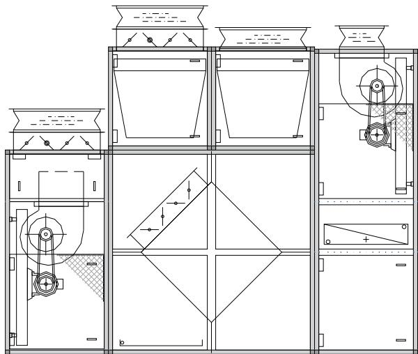
Комбинированный аппарат (приточный и рециркулирующий воздух) с пластинчатым теплообменником, заслонкой приточного воздуха и отработанного воздуха.
