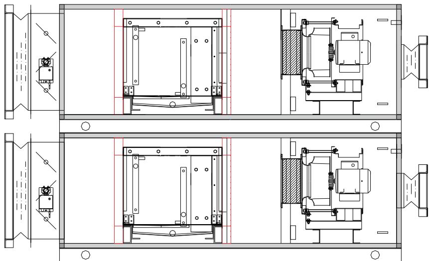
Аппарат приточного воздуха с сейсмостойкостью до 9 баллов по шкале Рихтера, ударопрочный, все детали устойчивы к дезинфицирующим жидкостям, рабочий и резервный блок со 100% резервом для всех функций. Заслонки канала наружного воздуха, теплообменники охлаждения и бескорпусные вентиляторы в специальном исполнении.
