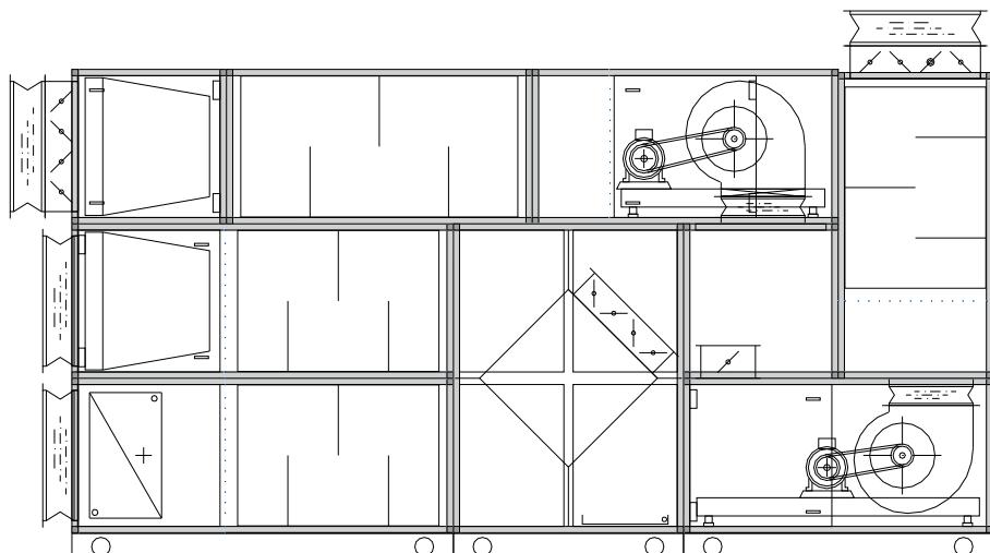
Комбинированный аппарат (приточный и рециркулирующий воздух) с пластинчатым теплообменником, рециркуляционной заслонкой, заслонкой приточного воздуха и отработанного воздуха, 4 глушителями шума в каналах наружного воздуха, приточного воздуха, рециркулирующего воздуха и отработанного воздуха. Контуры приточного воздуха: нагнетание вентилятором вниз, секция, поворачиваемая на 90°. Контуры рециркулирующего воздуха: нагнетание вентилятором вверх, выпускное отверстие сверху.
