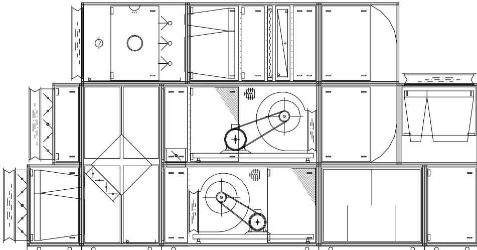
Комбинированный аппарат (приточный и рециркулирующий воздух) с пластинчатым теплообменником, рециркуляционной заслонкой, заслонкой канала приточного воздуха и канала отработанного воздуха. Контур приточного воздуха: секция, поворачиваемая на 180°, защита от намораживания льда, второй каскад фильтров, паровой увлажнитель. Контур рециркулирующего воздуха: воздухозаборник сверху, секция, поворачиваемая на 90°, глушитель шума.
