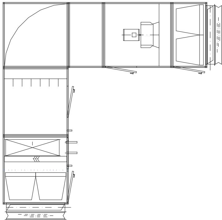
Аппарат приточного воздуха с бескорпусным вентилятором, секцией, поворачиваемой на 90°, паровым увлажнителем, спиральными теплообменниками охлаждения, вторым каскадом фильтров.
