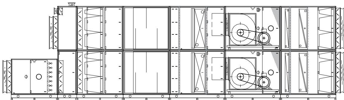
Аппарат приточного воздуха в гигиенической версии, рабочий и резервный блок со 100% резервом для всех функций. Заслонки канала наружного воздуха, несколько заслонок для зон приточного воздуха, многозонная система для приточного воздуха, содержащая паровой увлажнитель. Глушители шума в канале приточного воздуха, второй каскад фильтров.
