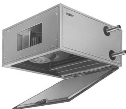
Радиальный вентилятор в качестве приводного блока с подшипниками качения, не требующими технического обслуживания. Вентилятор одностороннего всасывания. Вентилятор с прямым приводом. Однофазный двигатель с регулируемой скоростью вращения 230 В/ 50 Гц. Защита двигателя встроенными термодатчиками.
