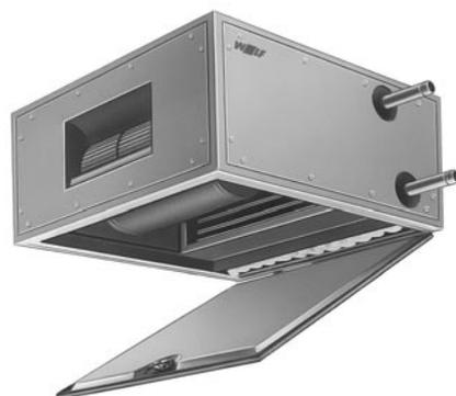
Радиальный вентилятор с подшипниками качения, не требующими технического обслуживания. Вентилятор с вперед загнутыми лопатками, двухстороннего всасывания. Привод с клиноременной передачей. Электродвигатель 3 х 400 В / 50 Гц. Защита двигателя встроенными термодатчиками или термисторами.
