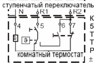
Коммутационная способность 6(3) А при напряжении 230 В / 50 Гц
