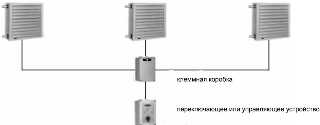
Клеммная коробка для параллельного соединения нескольких калориферов LH.
