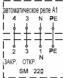
Серводвигатель для автоматического открытия и закрытия клапана наружного воздуха. Управление осуществляется через автоматическое реле А1.
